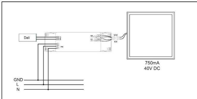
**B. Anschluss an einen beliebigen 750mA Konstantstrom LED- Betriebsgeräte**
