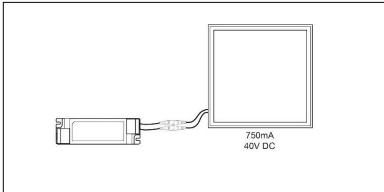
\*Schließen Sie die Leuchte nicht an ein eingeschaltetes LED-Betriebsgeräte an. Einige LED-Betriebsgeräte geben im Leerlauf eine hohe Spannung ab, was zu einer dauerhaften Beschädigung der Leuchte führen kann. Trennen Sie den LED-Betriebsgeräte unbedingt von der Netzleitung, bevor Sie die Leuchte anschließen.
